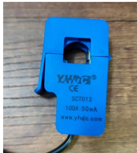
Figura 4-37: Sensor de corriente SCT013.
