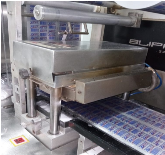
Imagen 1. Placa superior sellado. Muestra la placa de calentamiento y sujeción superior de la estación de sellado. (Elaboración propia).
