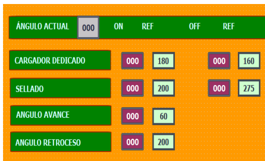
Figura 4. Ángulos máquina. Muestra las consignas para seguimiento de ángulos. (Elaboración propia).
