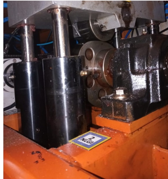
Imagen 2. Montante. Muestra el seguidor de leva y la leva de transmisión del movimiento mecánico. (Elaboración propia).
