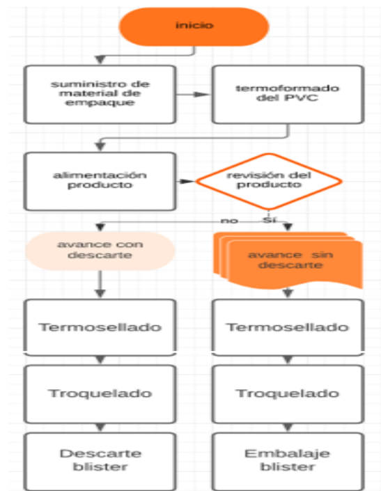
Figura 3. Diagrama de flujo blíster. Muestra flujo lógico de operación. (Elaboración propia).
