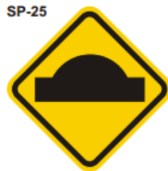
Figura 2: Señalización SP 25 resalto
