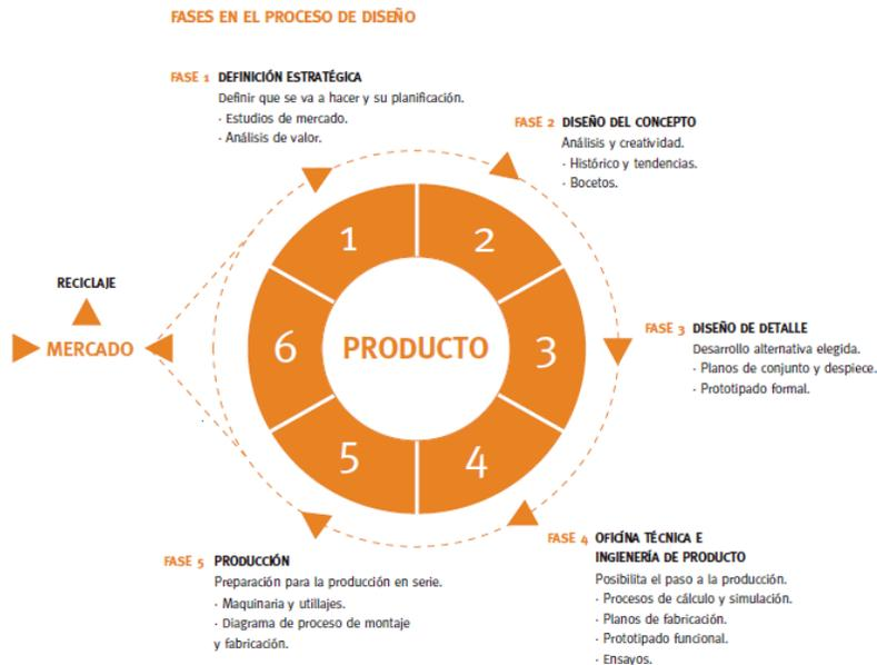
*Ilustración 4 Fases en el proceso de diseño (Fundación Prodintec, s. f.)*
