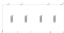
Altura interior del local: 2.800 m, Grado de reflexión: Techo 70.0%, Paredes 50.0%, Suelo 20.0%, Factor de degradación: 0.80
