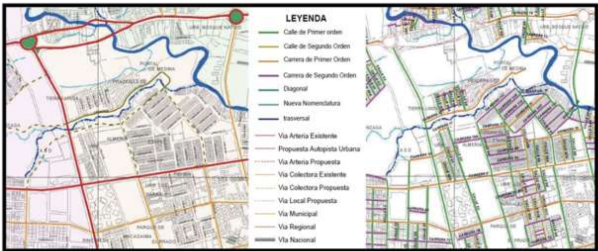
Figura 40: Sistema estructurante vial
