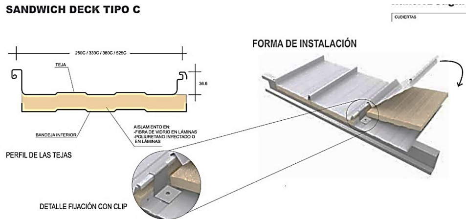
Figura 124. Ficha técnica cubierta tipo sándwich deck tipo c- Hunter Douglas. (NEWSLETTER, 2020)
