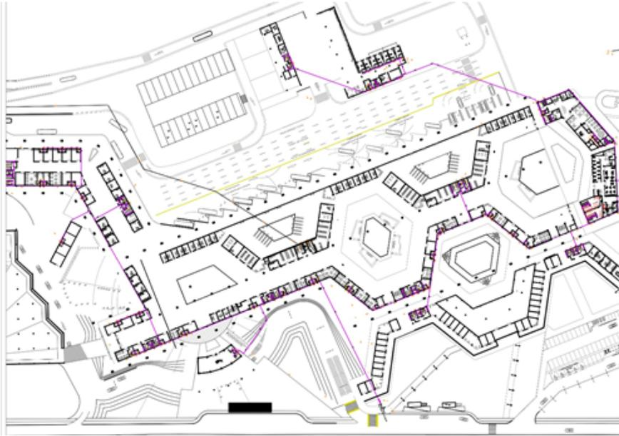
*Figura 105 Plano hidráulico de agua potable Fuente: (Autoria, 2020)*
