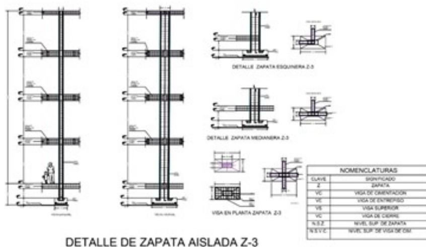
Figura 84 Detalle de zapata Z-3 Fuente: (Autoria, 2020)
