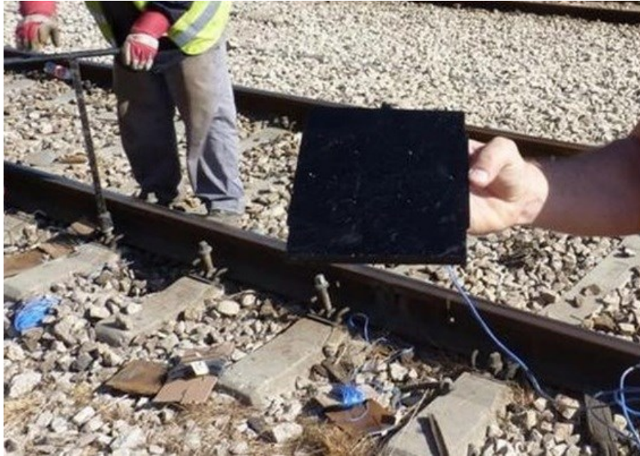
Ilustración : sistema piezoeléctrico Innowatech
