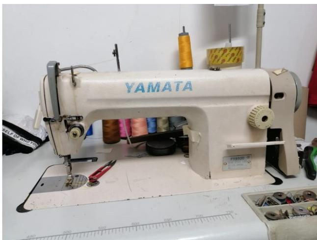
Figura 12. Máquina Plana marca Yamata.
