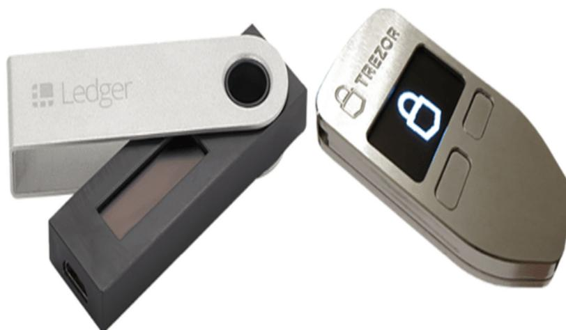
*Figura 17. Dispositivos que se conectan al computador únicamente al momento de envío de fondos Trezor y Ledger Nano*
