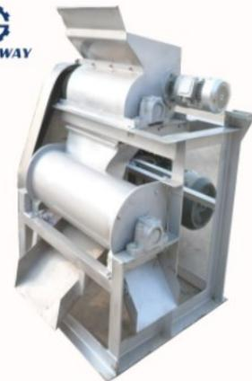
La capacidad esta entre 250 a 300kg de masa rallada por hora, el cilindro está compuesto por aspas que mezclan la masa con agua, la mezcla es tamizada en una malla de tela o nylon, se recomienda utilizar mallas de 120 mesh, para garantizar la calidad del almidón en relación al contenido de fibra e impurezas.
