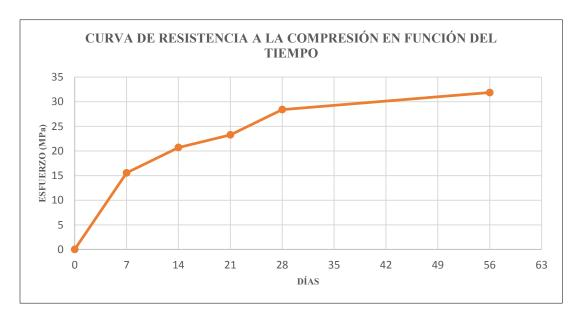
Figura 24 Curva de resistencia a la compresión en función del tiempo para la mezcla 1.
