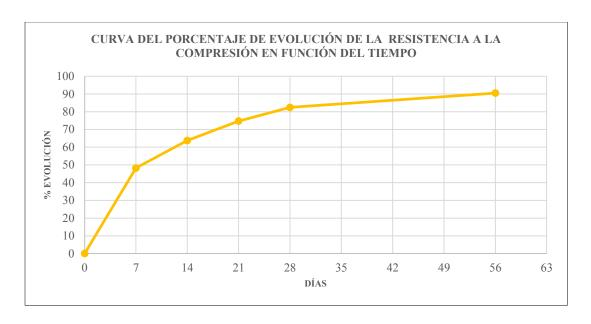
Figura 29 Curva del porcentaje de evolución de la resistencia a la compresión en función del tiempo para la mezcla 3.
