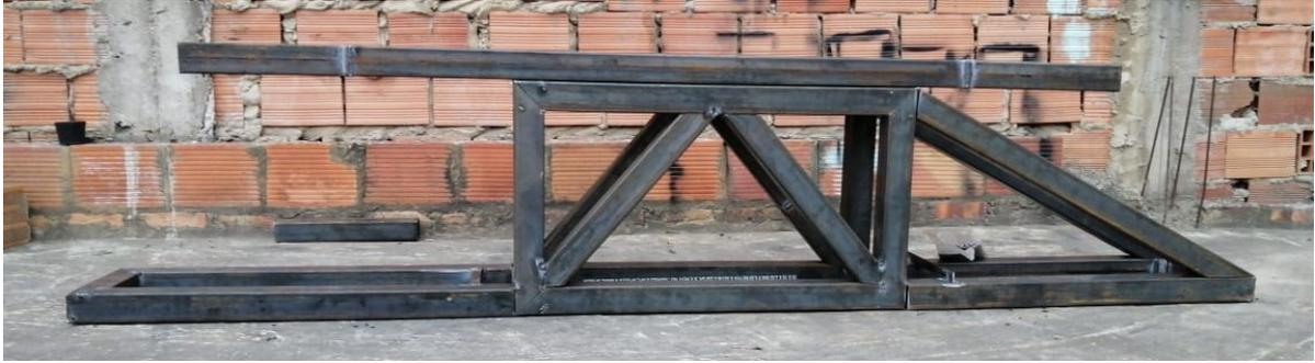
*Figura 46 Alargamiento y cambio de uniones rotativas a fijas.*
