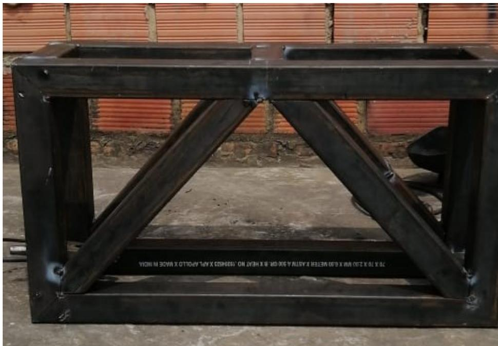
*Figura 44 Armado de diagonales en la estructura.*
