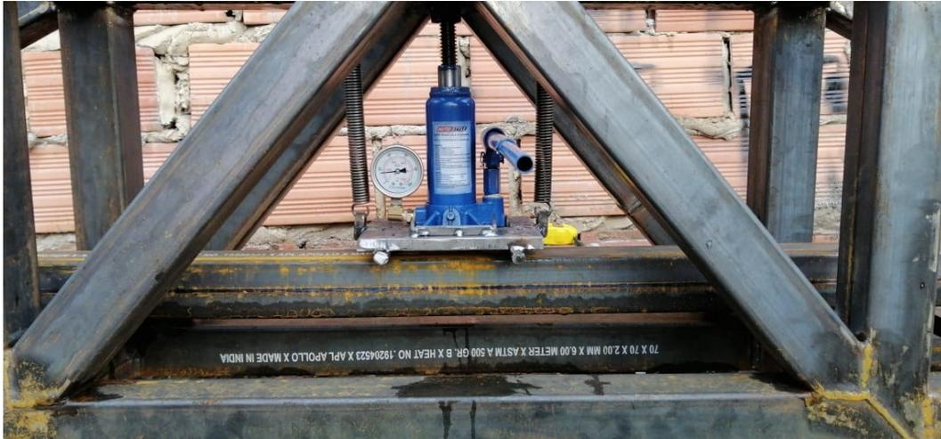
*Figura 51 Gato hidráulico montado en la estructura.*
