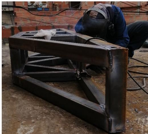
*Figura 54 Utilizando soldadura en las uniones.*
