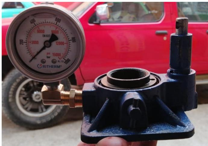
*Figura 47 Instalación del manómetro a el gato hidráulico.*
