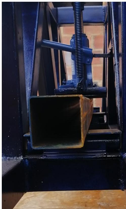
*Figura 60 La deflexión que obtuvo la viga al final del ensayo.*
