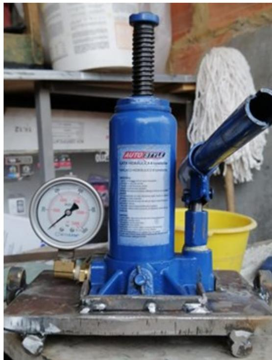
*Figura 18 Gato con el manómetro*
