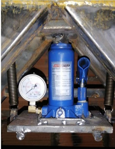
*Figura 53 Base superior del tornillo del gato hidráulico.*
