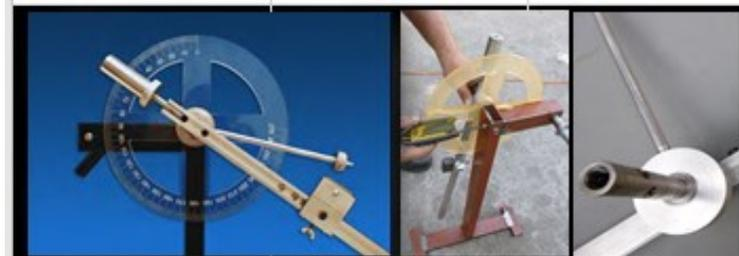
*Figura 7 Aparato para la demostración y medición de momentos*
