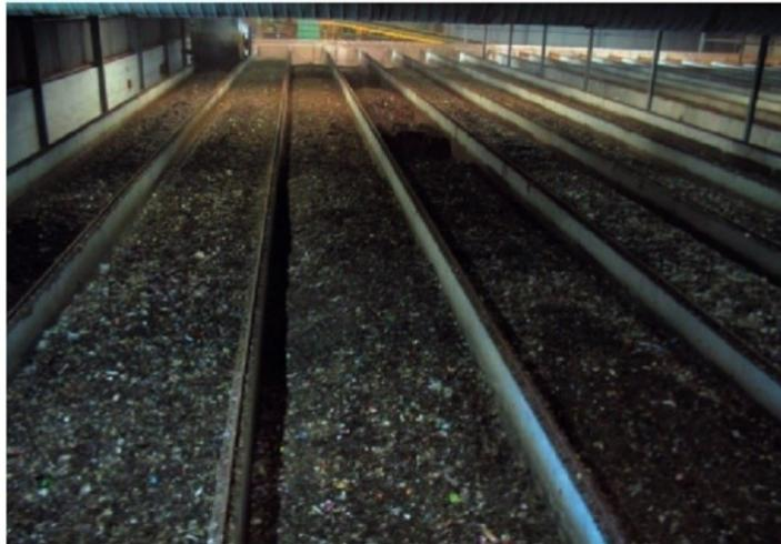
*Figura 6: Sistema semi-cerrado en el compostaje
