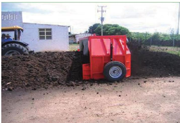
*Figura 4: Pilas con volteo en el sistema abierto de compostaje*
