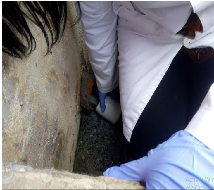
Figura 15. Toma de la muestra para solidos sedimentables. Fuente: HumanAmbiente S.A.S.
