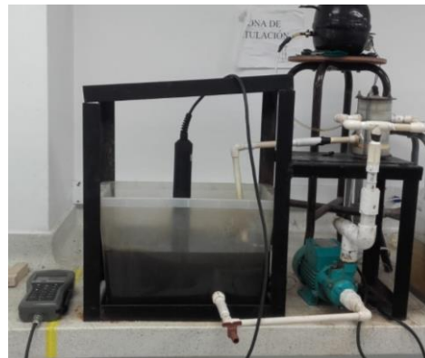
Figura.5. Medición de la diferencia ( \mu_{max} - b ) en un sistema de lodos activados con aireación de burbujas finas R4.
