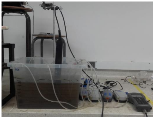
Figura.4. Medición de la diferencia ( \mu_{max} - b ) en un sistema de lodos activados con aireación convencional R3.
