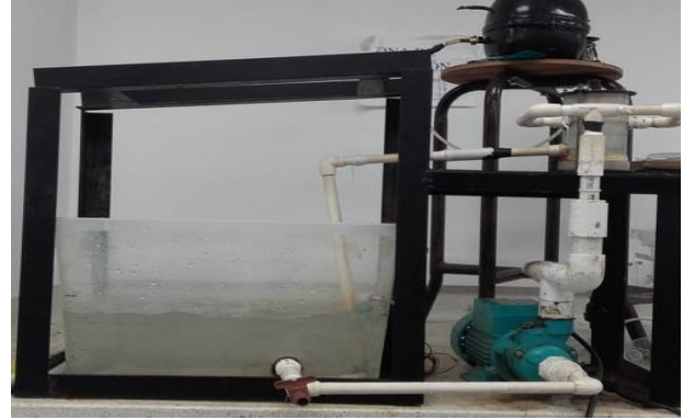
Figura. 2. Aireación con generador de burbujas finas.
