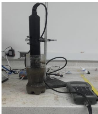
Figura. 3. Ensayo para estimar (b). Se mide OUR por medio de un multiparámetro Hanna 9829.
