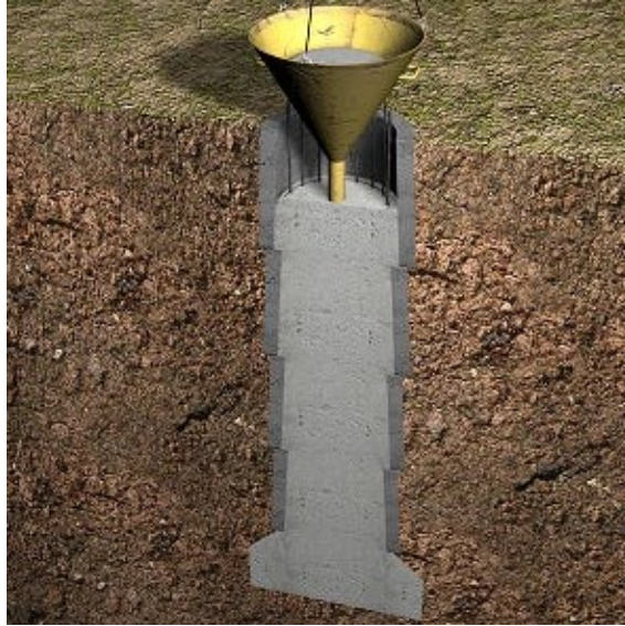
Figura 6. Seminario de Proyecto ingeniería Universidad Nacional. (2016). Pilote fundido Imagen tomada de https://marce-sweet24.wixsite.com/choco-late/blank-4
