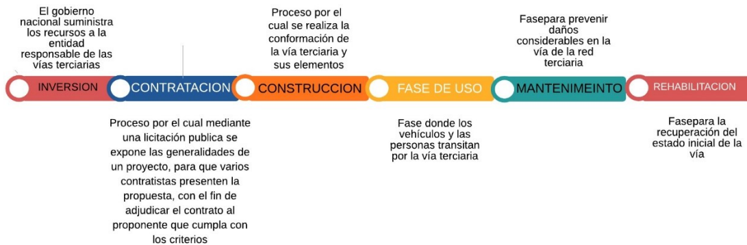
Diagrama 3 Autoría Propia. (2020). Fases de la vida útil de una vía terciaria en Colombia.
