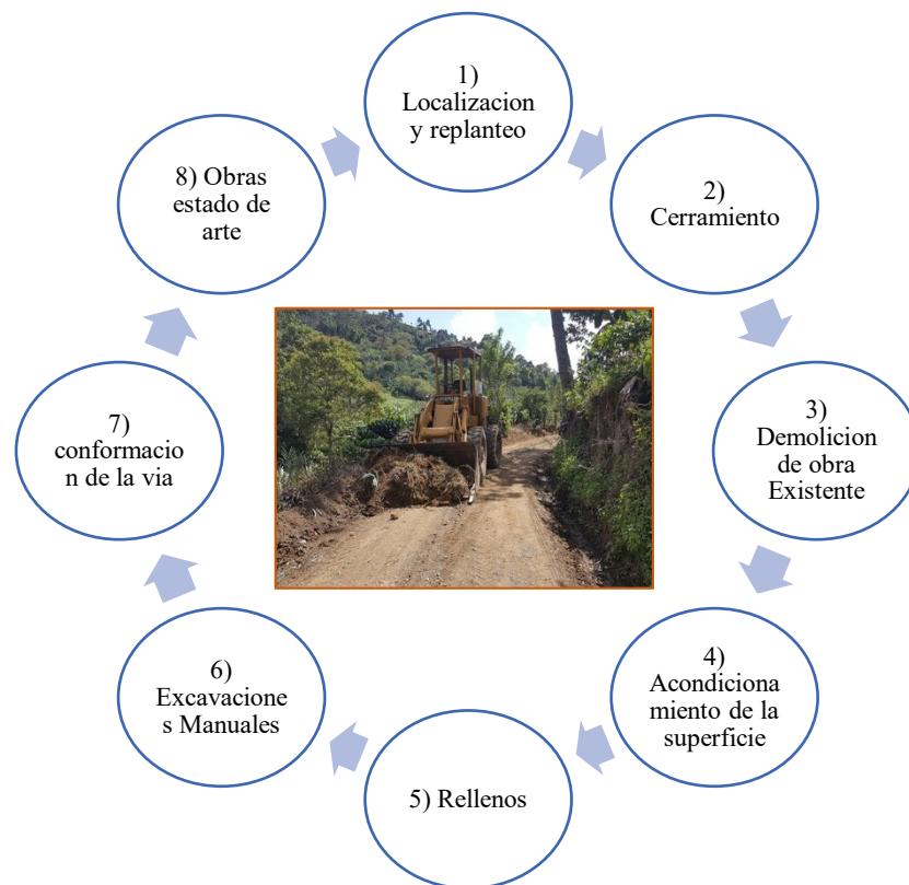
Diagrama 2 Autoría Propia. (2020). Diagrama para el proceso constructivo, mejoramiento o rehabilitación de una vía terciaria
