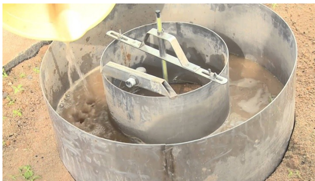
Figura 7 infiltrómetro de doble anillo.
