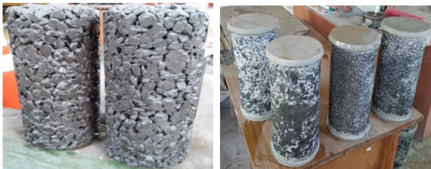
Figura 10 Ensayo de Compresión Tomado de (Pinto, Carrasco, & Caballero, 2020)
