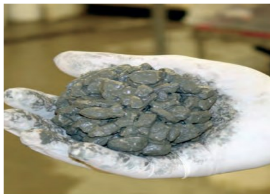
Figura 42 Mezcla de Concreto Permeable en Estado Fresco (Euclid Group Toxement, 2017).
