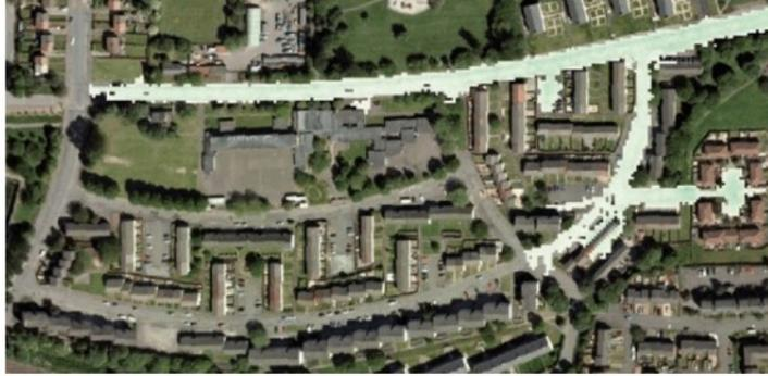
*Figura 4. Simulación del modelo en ITZI sobre las inundaciones. Obtenida de Itzi Model
