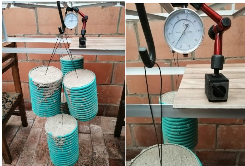
Ilustración 22 Montaje de estructura y lectura del comparador de caratula con 30 Kg
