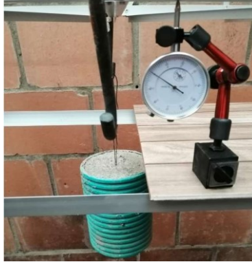
Ilustración 4 Deformación en cero cordones opuestos sometidos a carga
