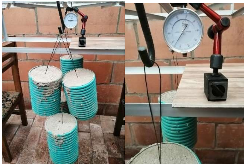
Ilustración 1 Montaje de estructura y lectura del comparador de caratula con 30 Kg
