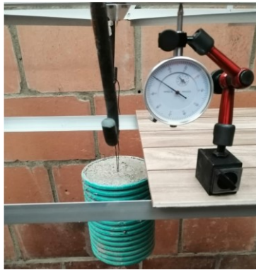
Ilustración 25 Deformación en cero cordones opuestos sometidos a carga
