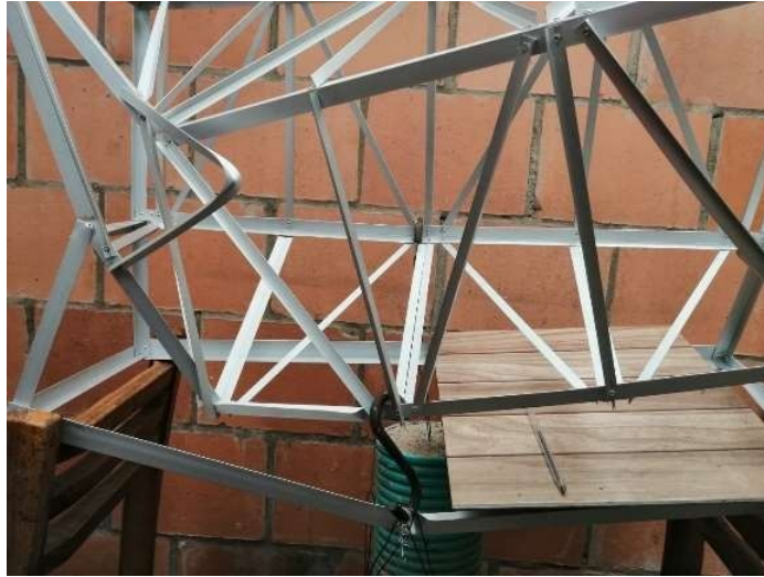
Ilustración 2 Torsión en diagonal estructura No. 2
