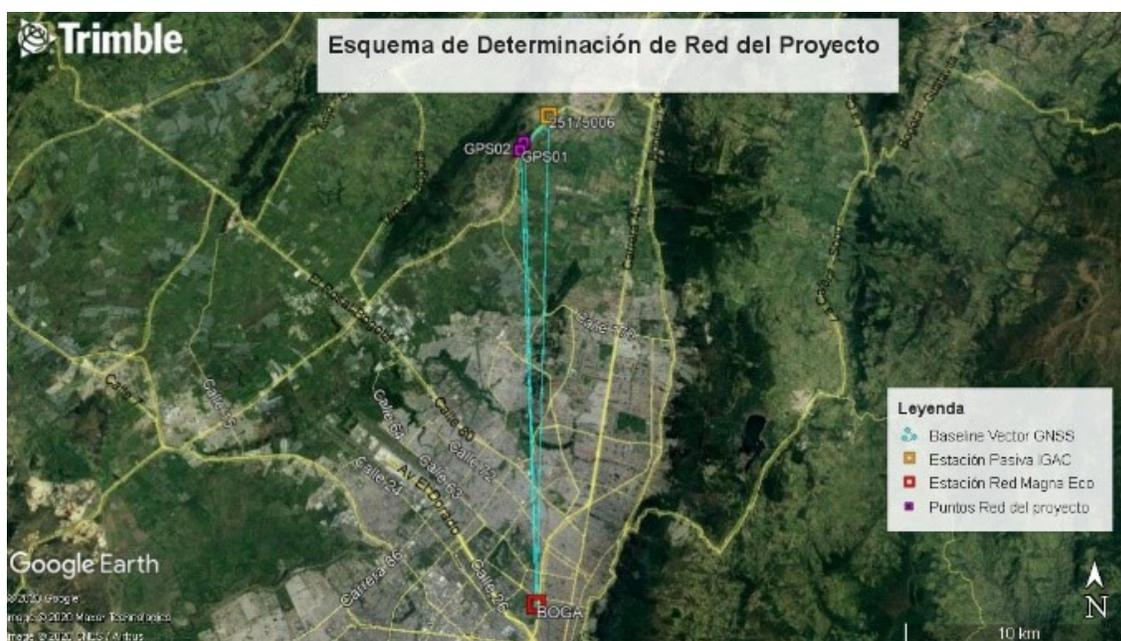
*Ilustración 9. Esquema de determinación de Puntos GPS-01 y GPS-02. Fuente propia*
