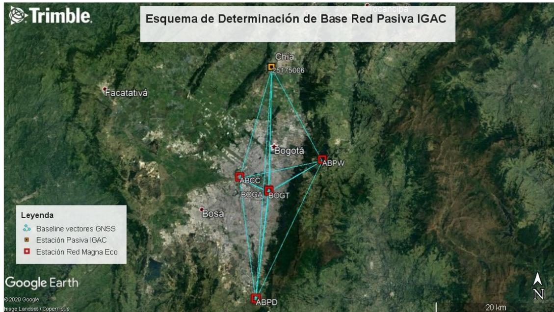
*Ilustración 8. Esquema de determinación de bases GPS. Fuente propia*
