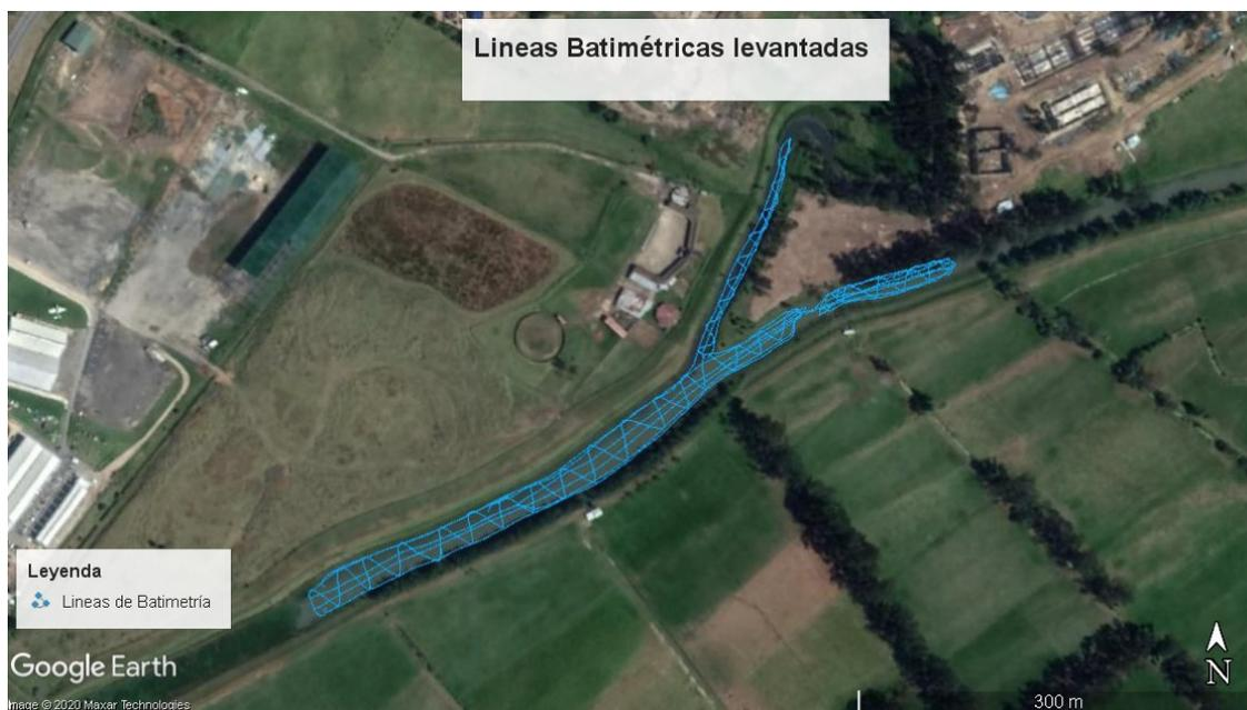
*Ilustración 15. Líneas batimétricas levantadas mediante Ecosonda Monohaz. Fuente propia*
