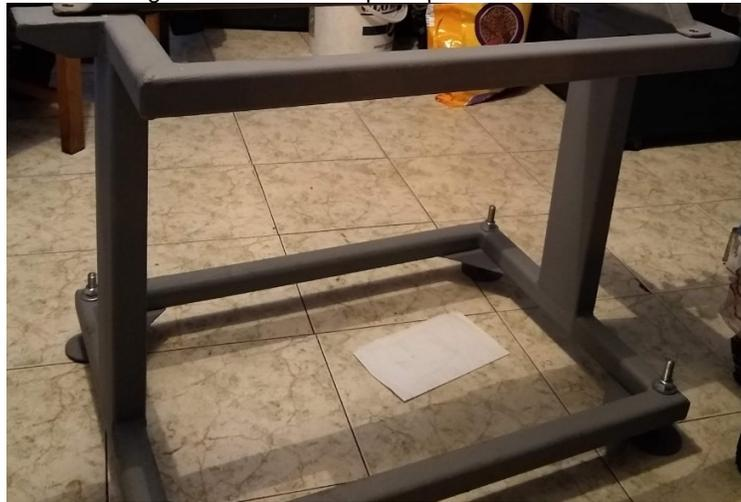
Como se puede observar en la figura anterior, se presenta la mesa de soporte completamente fabricada, donde se detallan los elementos estructurales que se mencionaban anteriormente, además se puede observar que se presenta ya con una base anticorrosiva aplicada esto para evitar principios de oxidación y proceder a sus detalles de pintura para finalizar el proceso de construcción.
