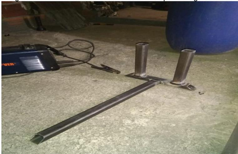
En la figura anterior se observa la fase resultante del soporte construido, donde se observa ya un elemento prácticamente armado solo faltando unos ángulos de inclinación que servirán para sujetar la base a la mesa principal de apoyo del mecanismo oscilante.
