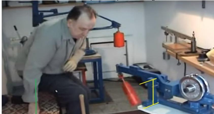
Como se observa en la figura anterior se marca la altura de uno de los soportes verticales de color amarillo y se procura relacionar con parte del antebrazo del autor y determinar una medida aproximada y adecuada para esa sección, además que esta nos va a permitir variar la altura de la viga para realizar futuras pruebas o ajustes que requiera la viga oscilante para un buen funcionamiento.
