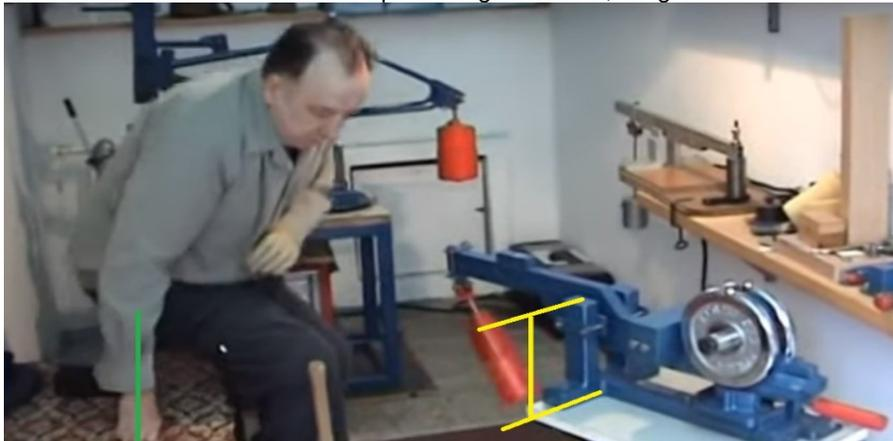
La distancia que habrá entre los travesaños será definida cuando se determine la sección indicada para la viga oscilante ya que esta distancia no podrá ser tan extensa, puesto que durante la operación puede ocasionar que la viga oscilante tenga movimientos desbalanceados por las vibraciones que presente al momento de realizar el impulso hacia las bombas ocasionando posibles problemas de diseño.
