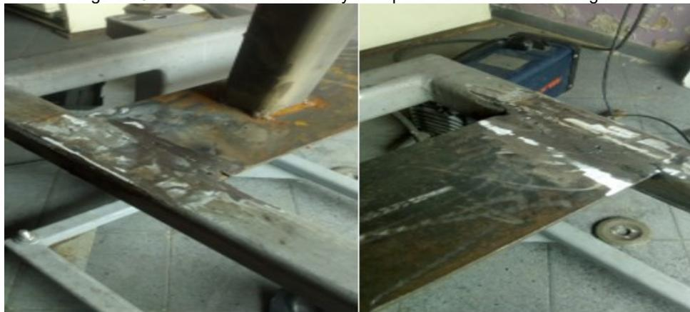
En la figura anterior se observar la sujeción de una platina que fue necesario instalar para sujetar el tubo que soportaran las bombas de diafragma, a continuación, se observa su terminación en la estructura.
