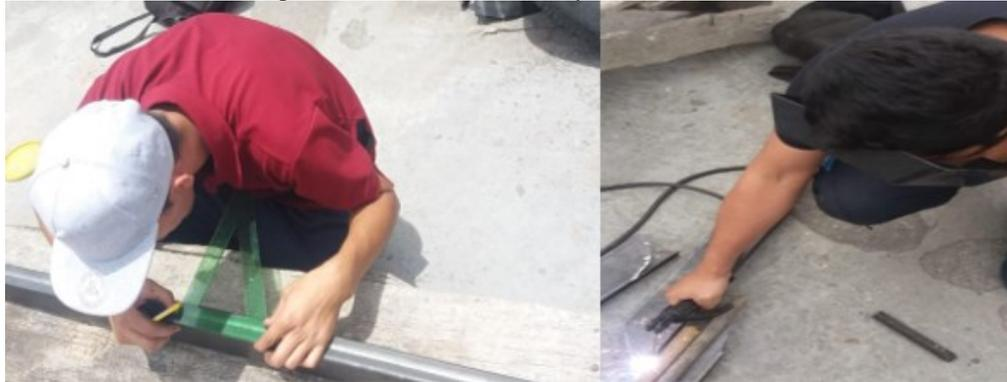
Se repite el mismo proceso para continuar con la construcción total de mesa, pero se utiliza una sección de tubo rectangular que será ubicado en los extremos de la estructura y que soportaran la parte superior de la mesa ya que estos servirán como refuerzos para tolerar la energía mecánica que genere la oscilación del péndulo y la viga oscilante.
