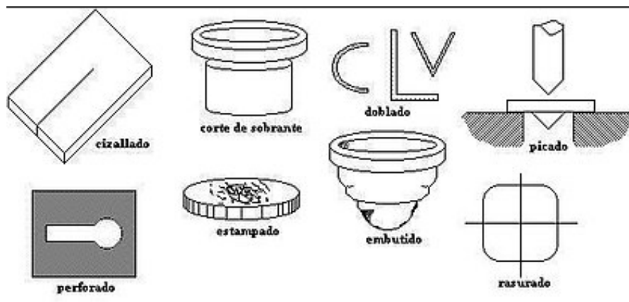
Figura 10. Aplicación de troqueles simples.
