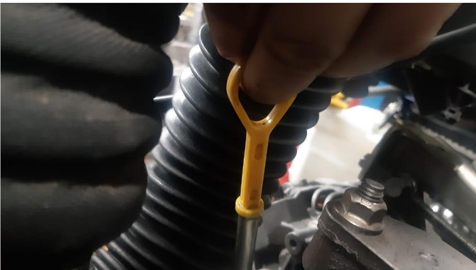
**Imagen 4.** Bayoneta de medición de aceite de motor.
