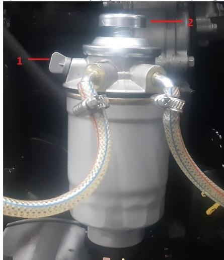
Este procedimiento se debe realizar para evitar burbujas de aire en la tubería de combustible que puedan afectar la presión inicial y generen problemas para el encendido y cavitación. Ya cuando el motor lleva un tiempo funcionando, el sistema no presenta aire y
