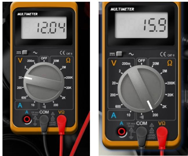
En el caso que se requiera medir la resistencia de un elemento, este debe estar previamente desconectado del sistema, y se medirá directamente de la conexión del sensor o actuador. El rango de trabajo dependerá del elemento, para eso se tendrá que consultar la tabla de información de dicho objeto.
