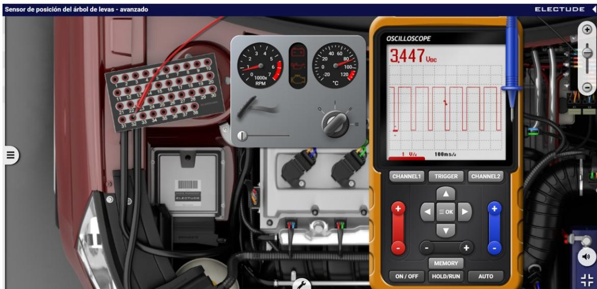
Al realizar cambios de revoluciones en el simulador, se puede ver que el cambio principal, es el aumento de la frecuencia de la onda cuadrada, cada señal cuadrada producida por el sensor, indica el siguiente tiempo de expansión del pistón 1, pero la amplitud del voltaje se conserva, muy diferente al sensor del cigüeñal.
