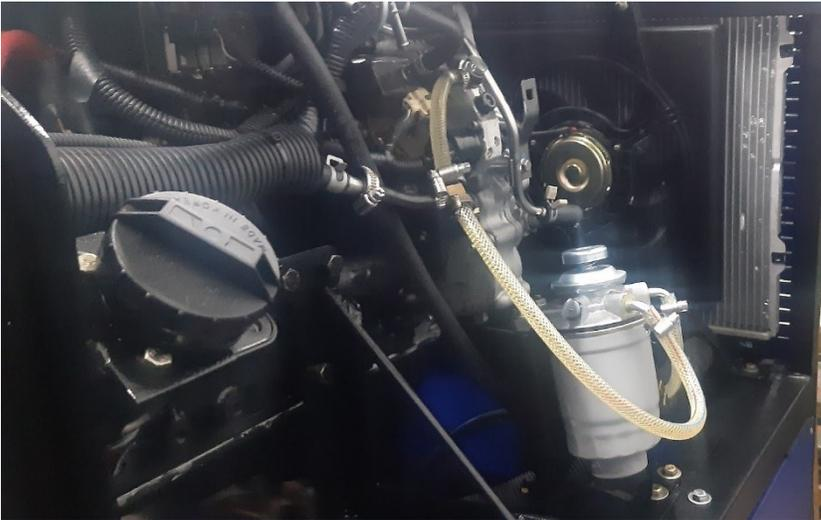
**Imagen 3.** Fotografía del conducto de combustible, también se aprecia el filtro de combustible y la válvula de purga.
