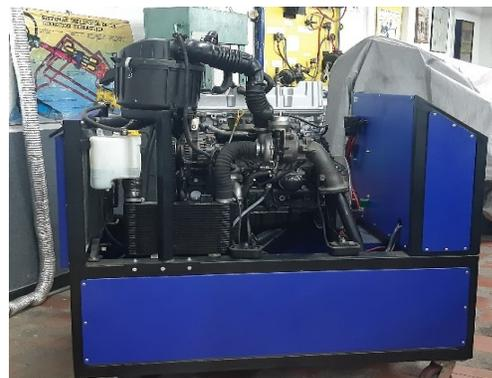
**Imagen 1.** Áreas principales de un motor y fotografía del motor Mazda BT50.
