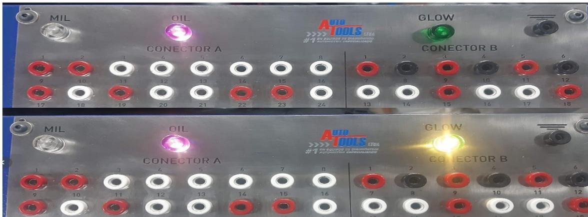
El bombillo de la derecha siempre debe realizar ese encendido y apagado cada vez que se accione la llave de encendido, también los primeros treinta segundos de funcionamiento del motor para indicar que las bujías incandescentes están funcionando correctamente.
