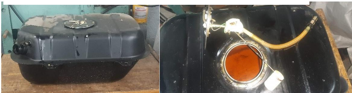
Como se aprecia en la ilustración, el interior del tanque presenta oxidación así que se realiza un lavado interno antes de su ensamblaje nuevamente. Otros elementos que se corrigieron fueron las conexiones eléctricas del motor, una limpieza a las terminales con productos químicos para la eliminación de suciedad y óxido fue utilizado para esto.
