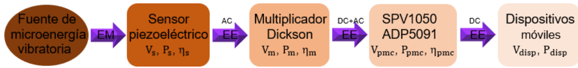
Figura 3-60: Análisis desacoplado del sensor piezoeléctrico
