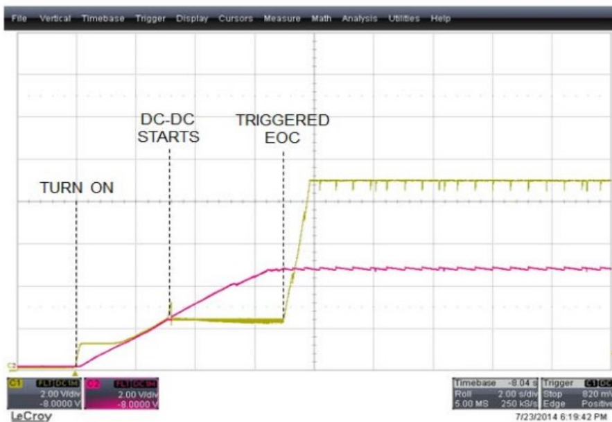
Figura 2-12 Inicio del dispositivo en configuración Buck-Boost.
