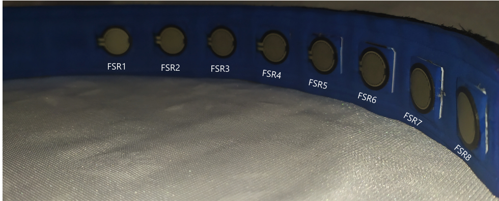
Figura 5-5.: Identificación Sensores FSR
