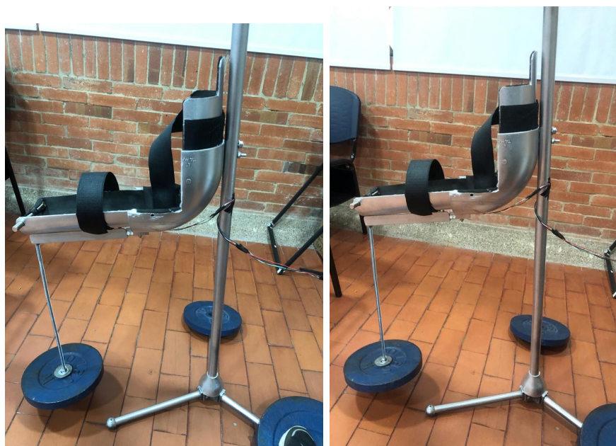
Figura 3-12: Calibración de celda de carga con pesas patrón. Imagen de autor.
