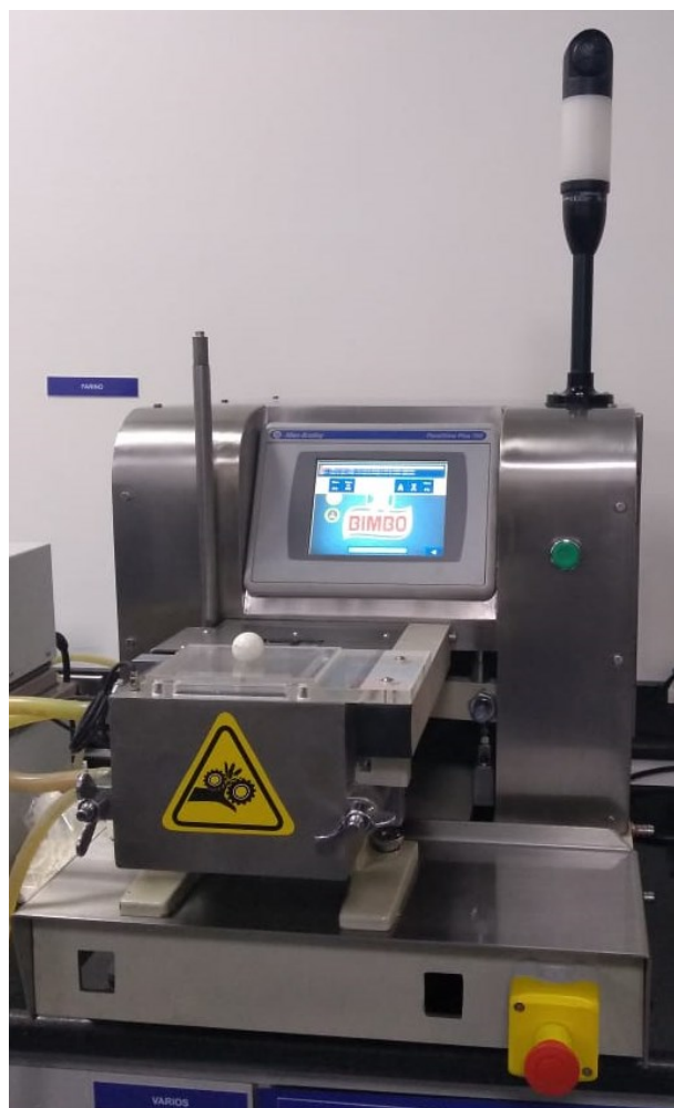
Figura 3-39. Construcción final del farinógrafo.
