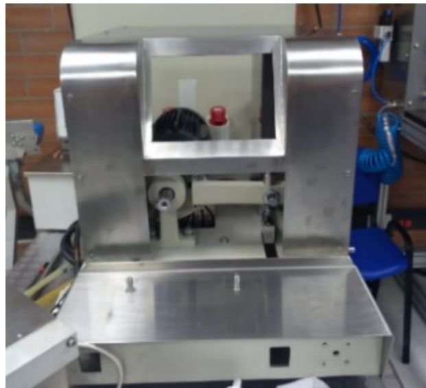
Figura 3-21. Construcción del diseño del farinógrafo.
