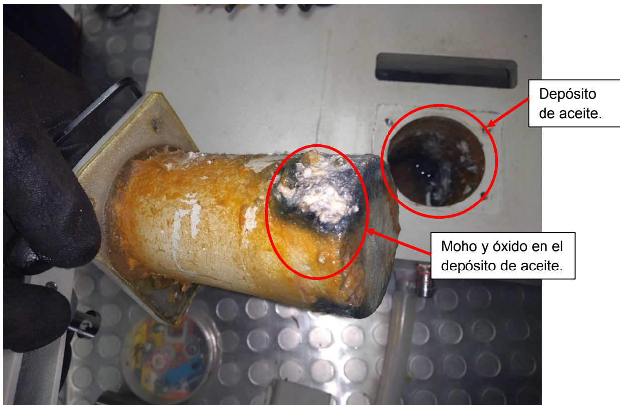
Figura 3-3. Depósito de aceite.
