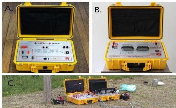
Adicionalmente el equipo utilizado en campo tiene como accesorios fundamentales los siguientes componentes: cables conectores, electrodos, fuentes de voltaje y una Computadora. En la Figura **2-2** se aprecia la imagen del montaje de un electrodo en campo.
