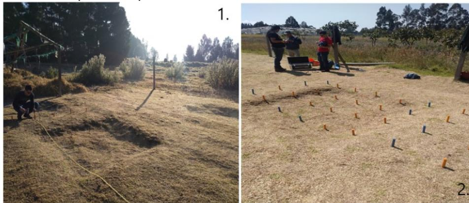
**Figura 2-9:** Toma de datos con Penetrologger UAN.
