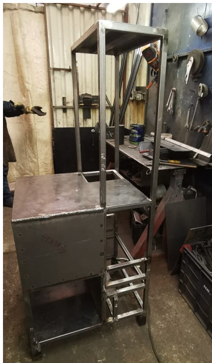
Figura 4-1: Construcción de banco de pruebas para alternadores.
