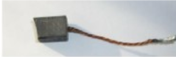
Figura 1-2: Daño en escobillas:
