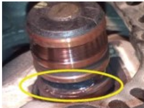
Figura 1-3: Anillo deslizante entallado por escobilla.
