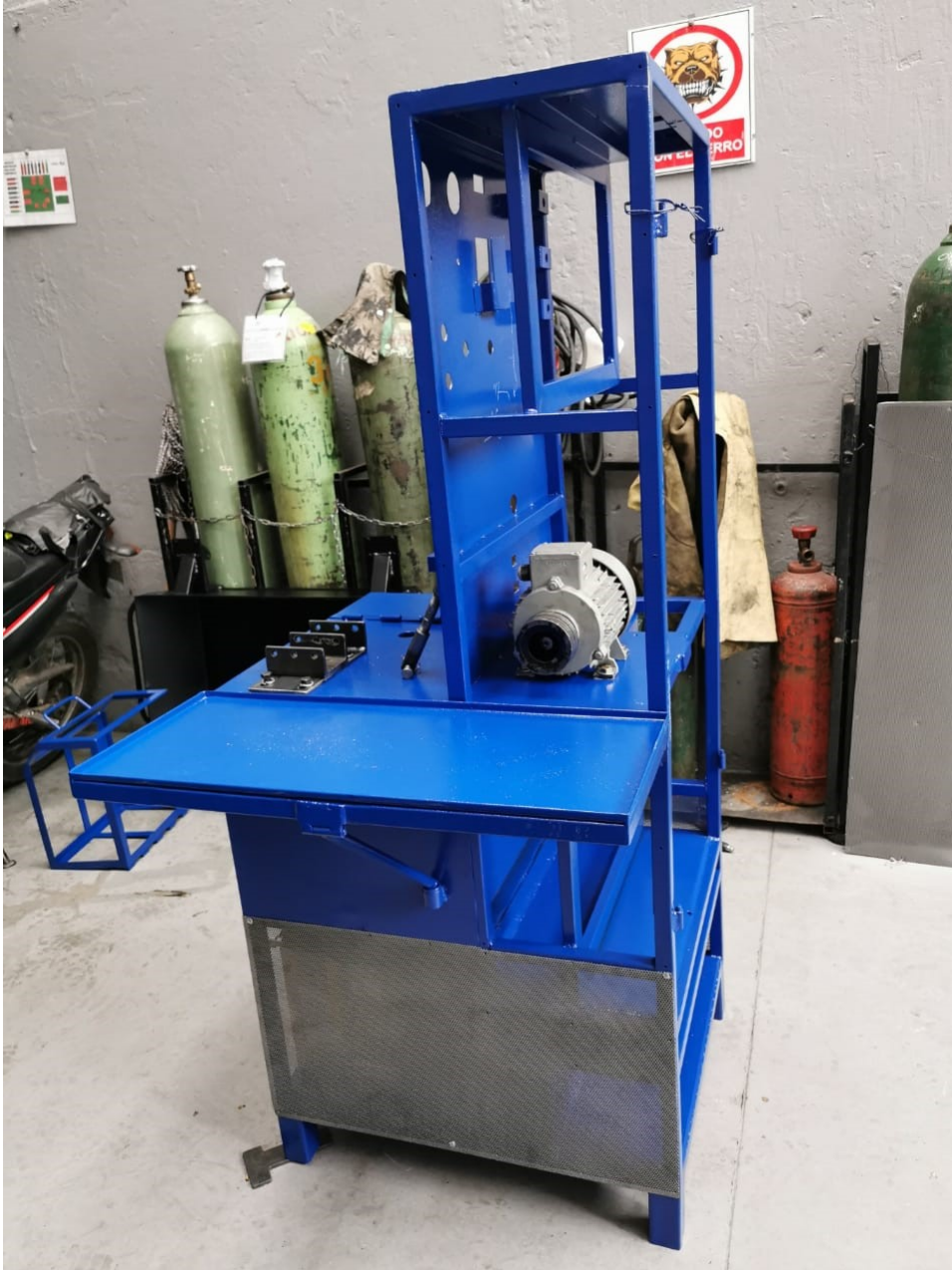
Figura 4-6: Estructura base para banco de pruebas para alternadores.
