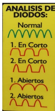
Figura 5-17: Señales de osciloscopio.
