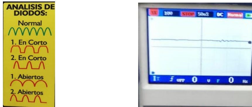
Figura 5-24: Análisis en osciloscopio.
