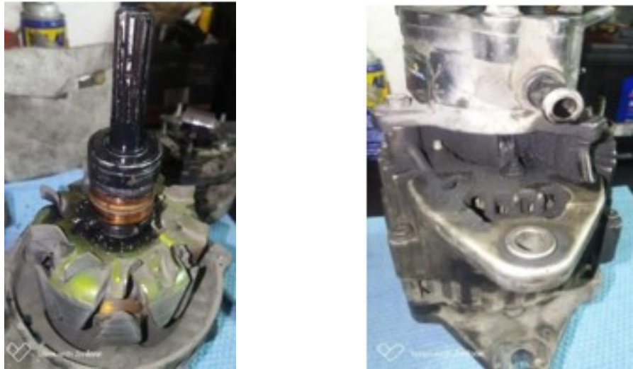
Figura 1-4: Rotor húmedo por fuga en bomba.
