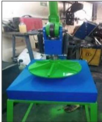
Figura. 9 Troqueladora de corte manual. Máquina de punto muerto manual.
