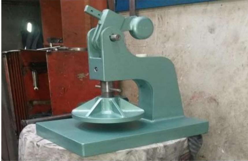
Figura. 49 Troqueladora construida y en funcionamiento.
