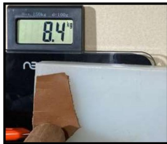
Figura. 18 Pruebas de corte
