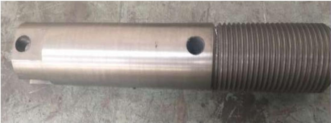
Figura. 44 Eje-corredera soporte disco
