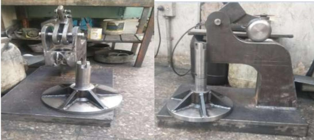
Figura. 446 Construcción de la troqueladora.
