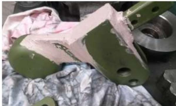
Figura. 47 Aplicación de masilla para distribución de esfuerzos.
