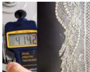
Figura 15 Medida de tacómetro y defectos producidos en la tela por cambios de velocidad. Fuente propia
