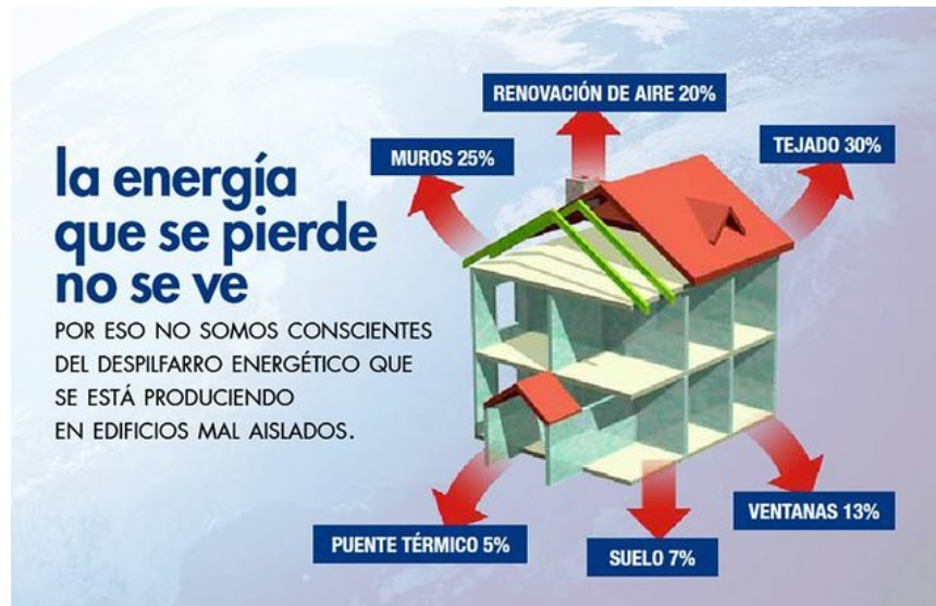
Figura 2 Aislamiento en diferentes partes de la vivienda (Asociación de Ciencias Ambientales;, s.f.)
