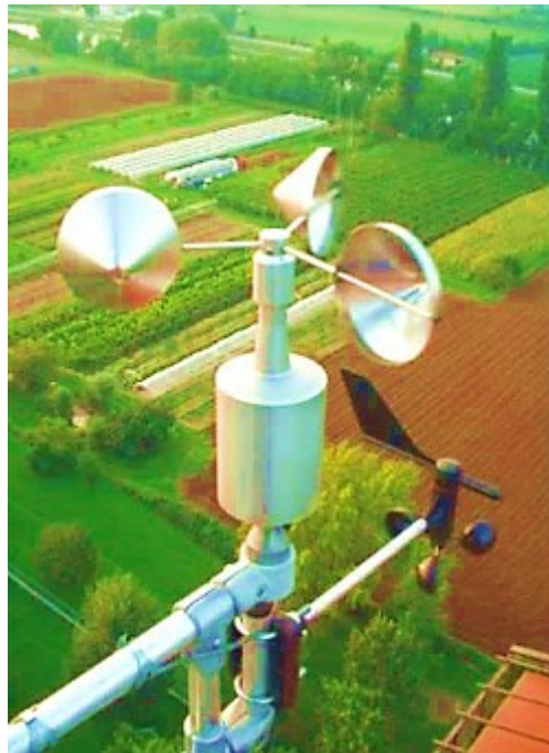
Figura 1. Anemómetro de cazoletas tipo Robinson. Fuente: (Ruiz Murcia et al., 2017)
