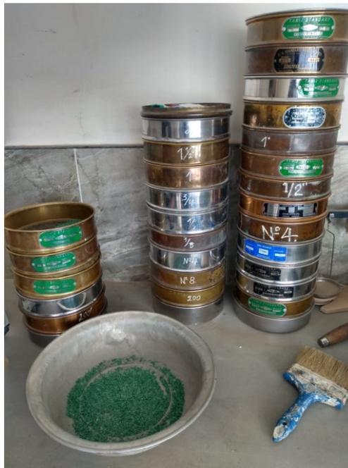
*Figura 9. Ensayo granulometría plástico HDPE (Tamizado) bajo parámetros NTC 77 (ICONTEC, 2007).*
