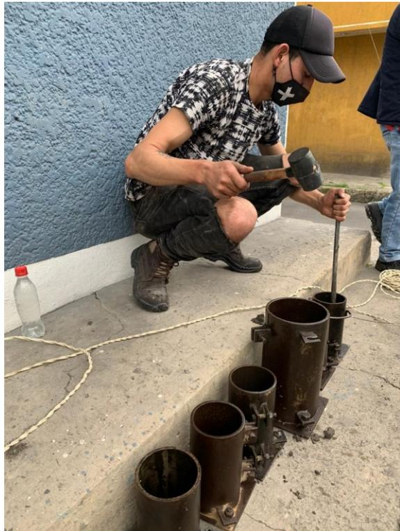
Elaboración de cilindros compactación mediante varilla y martillo de goma
