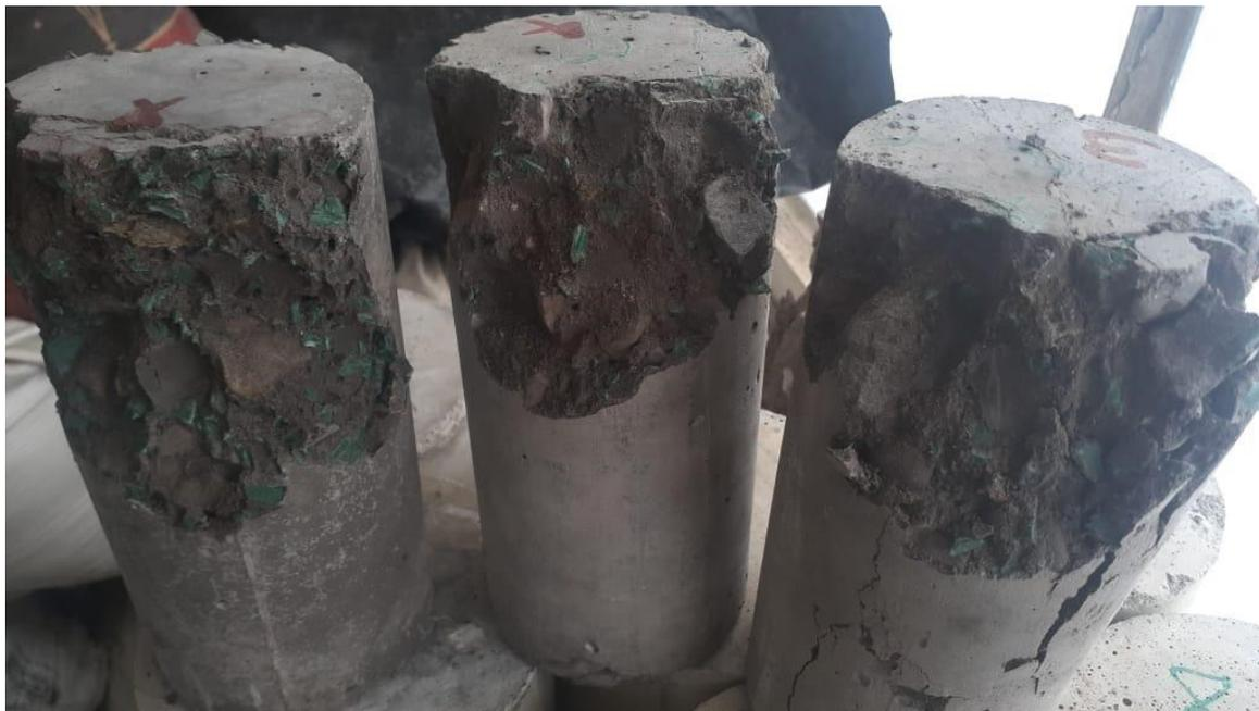
Ensayo a compresión y muestra de cilindros fracturados.
