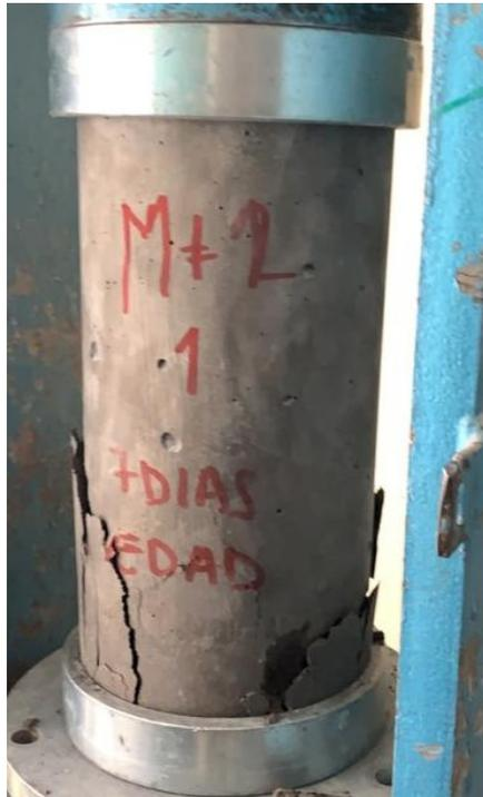
*Figura 21. Fallo espécimen cilíndrico muestra 1 (0% Reemplazo). Edad 7 días*
