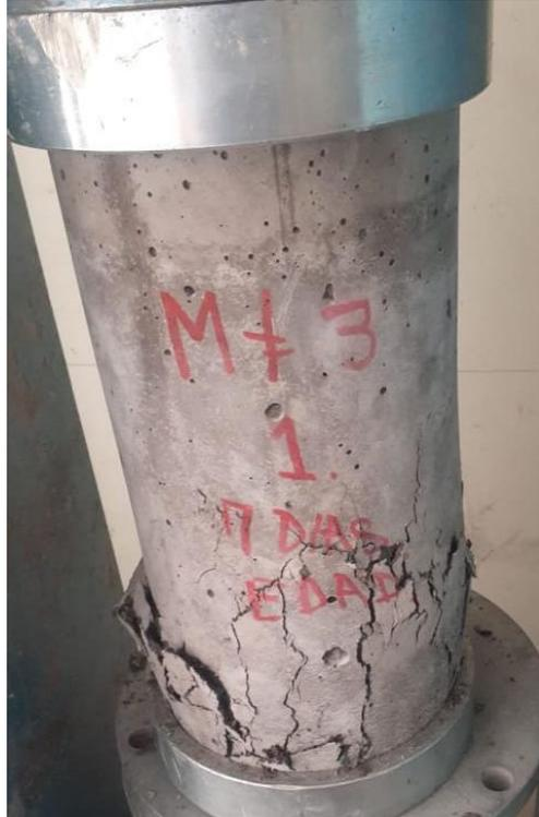
*Figura 23. Fallo espécimen cilíndrico muestra 3 (20% Reemplazo). Edad 7 días*
