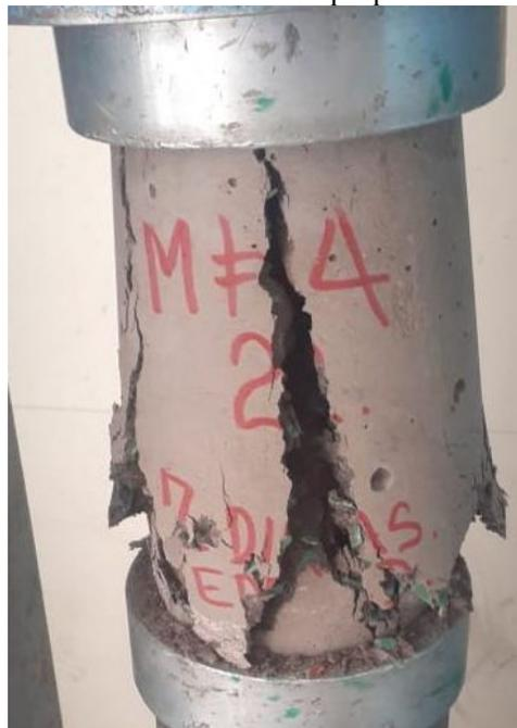
*Figura 24. Fallo espécimen cilíndrico muestra 4 (30% Reemplazo). Edad 7 días*
