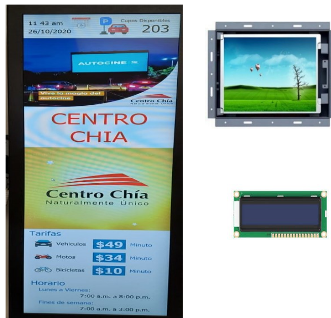
Figura 3. Pantallas informativas del expedidor de tarjeta, se presentan tres de los modelos adaptables. Autoría propia.
