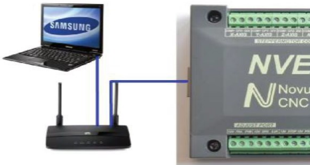
Figura 2- 8: Forma de conexión por medio de router
