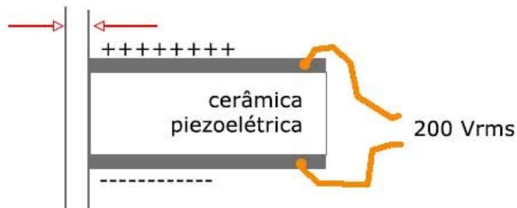
Ilustración 16, Bobina piezo-eléctrica, (<https://www.incb.com.mx/index.php/articulos/53-como-funcionan/1041-como-funcionan-los-solenoides-mec006s>)
