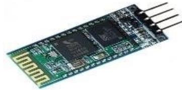
**Figura 4: modulo bluetooth HC-06.** (www.arduino. cc)
