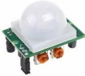
**Figura 5: sensor pir de Arduino. ([www.arduino.cc](http://www.arduino.cc))**
