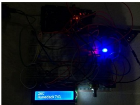
Figura 16, Sistema de medición de temperatura y humedad (elaboración propia).
