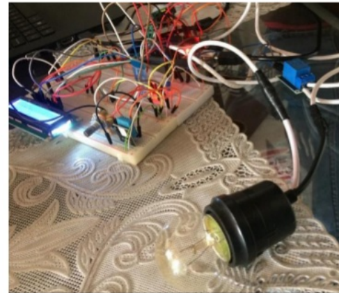
Figura 14, encendido de una bombilla por bluetooth (elaboración propia)
