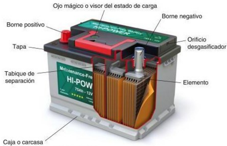
Figura 1-6: partes de una batería
