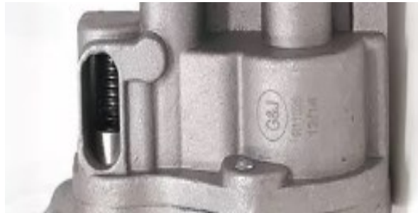
Figura 19: Válvula de alivio de la bomba de engranajes [2.3]
