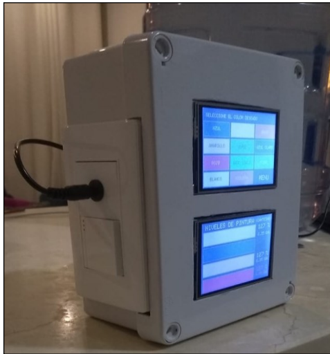
Figura 33: Vista diagonal de la caja de control y HMI del dispensador de pintura [3.1]
