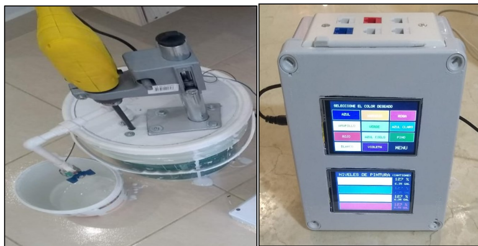
Figura 37: Sistema dispensador en funcionamiento [3.1]
