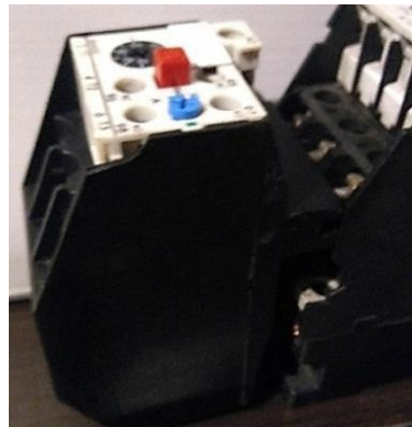
Figura 2-15: Térmico con contactos auxiliares
