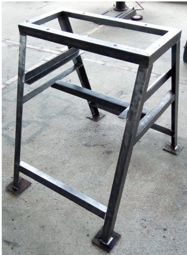
Figura 3-22: Construcción estructura banco de alineación didáctico
