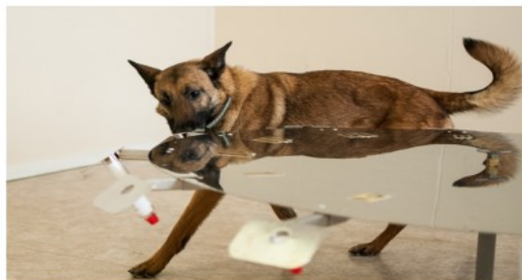
Figura IV. Schoon et al. (2014) Perro olfateado y discriminando muestras de corrosión.
