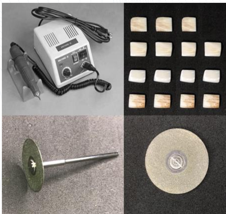
Ilustración 5: Micro motor y disco que fue utilizado para manera obtener las 15 muestras.
