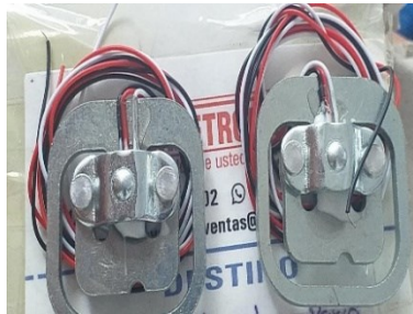
Figura 14 Celdas de carga. (Autor)
