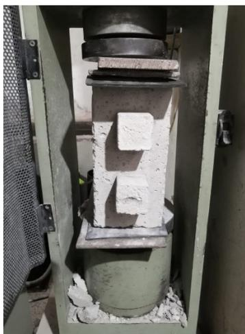
*Figura 11. Ensayo resistencia a la compresión bloque-espécimen Garzón M & Clavijo F, 2020.*
