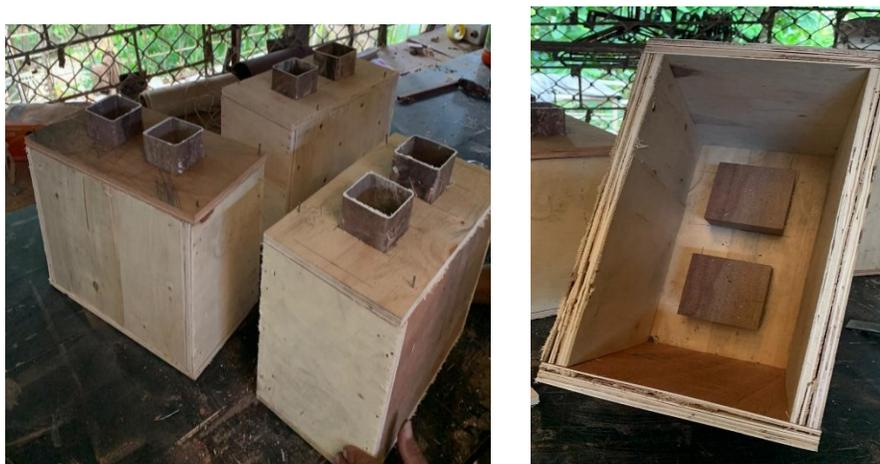
*Figura 2. Moldes en madera para los bloques por Garzón M & Clavijo F, 2020.*
