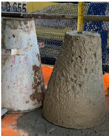
*Figura 3. Ensayo de asentamiento del concreto por Garzón M & Clavijo F, 2020.*
